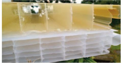
Wenn schon Sanierung, dann energetisch richtige Sanierung: oben ist die alte Doppelstegwand einzellig und verfärbt zu sehen, unten die neu verbaute mit 5 Zellen! Dies bedeutet einen enormen Zuwachs an Isolation, gut im Winter aber auch gut im Sommer. Für Fachleute hat die neue 5-fach Stegwand folgende technische Isolations-Eigenschaften: Up-Wert 1,1 W/qmK bis 1,2W/qmK nach DIN EN ISO 6946:2008
